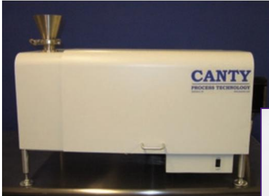
LabPlus SolidSizer™ avec contrôle automatique par ethernet 10 micron - 50 mm Option
